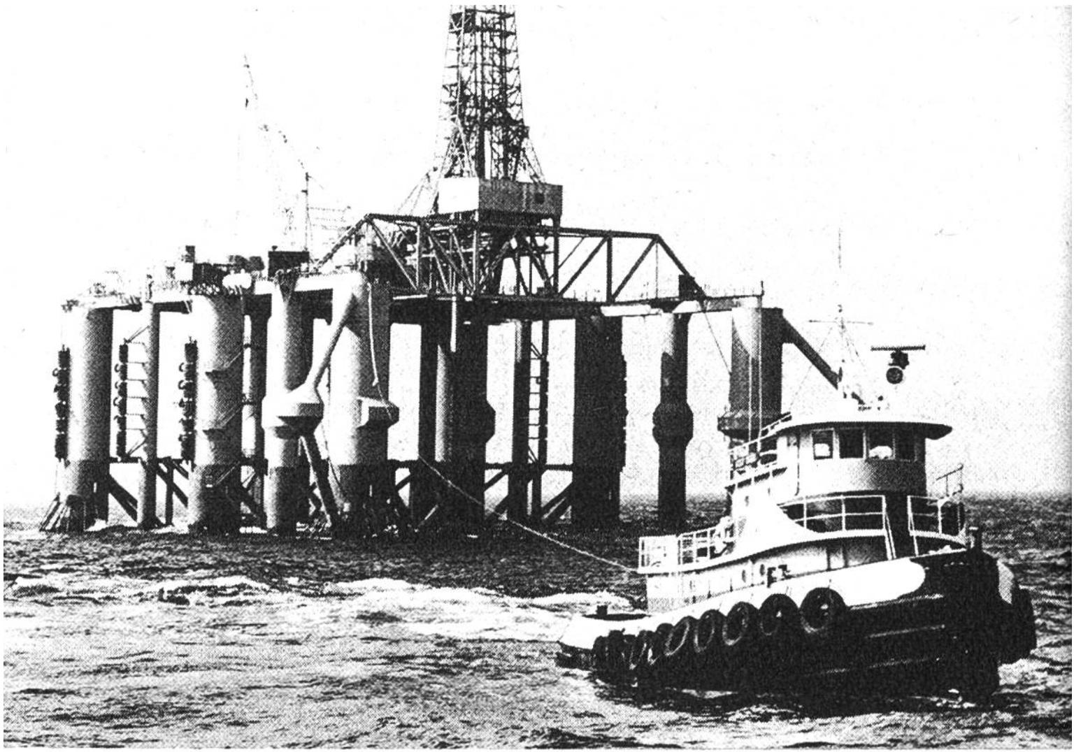
*Die schwimmende Bohrplattform wird im Golf von Mexiko von Schleppern an die neue Bohrlokation gezogen, wo die Plattform auf den nicht allzu tiefen Grund abgesenkt werden kann. Das Gesamtgewicht der Anlage beträgt gegen 7000 Tonnen.*
