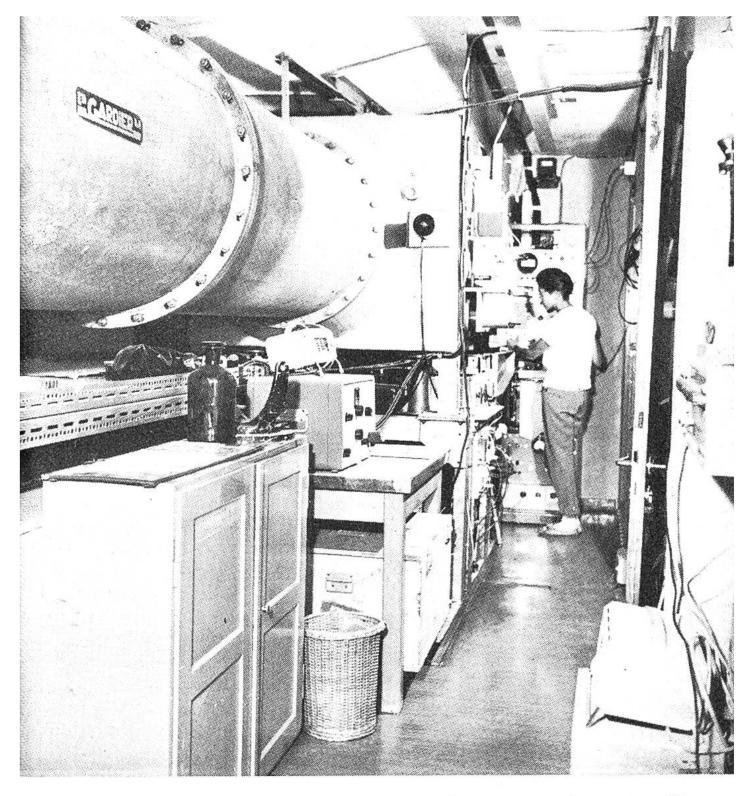
Spektograph zur Analyse des Sonnenlichts. Diese Anlage von über 10 Tonnen Gewicht vermag Wellenlängen von 1/1 000 000 000 mm zu unterscheiden.
