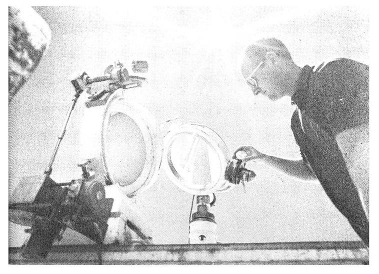
Mit einem speziellen Spiegelsystem wird auf der Terrasse des Sphinx-Observatoriums das Sonnenlicht eingefangen und durch ein Kamin zu den Apparaturen in den Laboratorien geblendet.
