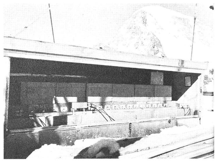
Apparatur zur Registrierung der kosmischen Strahlung. Ein kosmischer Strahlungspartikel erzeugt über eine Kette von Reaktionen auf der Hochspannung der Zählrohre von 2000 V während 1/100000 Sekunde eine Veränderung von 1/1000 V, die dann verstärkt und auf einem Zähler festgehalten wird.
