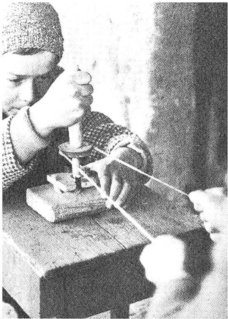
*Der zu durchbohrende Stein liegt zwischen den zwei gut fixierten Brettchen. Der Hohlbohrer dreht sich in einem weiteren hohlen Stab als Führungshilfe. Dem Bohrer ist ein Sandsteinrädchen aufgesetzt, in dessen Rille man eine Schnur hin und her zieht.*
