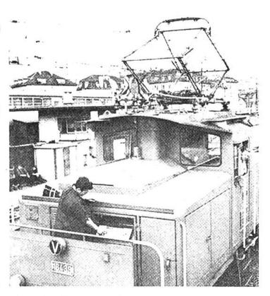
Auch die Rangierlokomotiven sind mit Gleismelderanlagen ausgerüstet, so dass während der Fahrt eine neue «Rangier-Fahrstrasse» bestellt werden kann. Die Verbindung zum Zentralstellwerk erfolgt über Funk.
