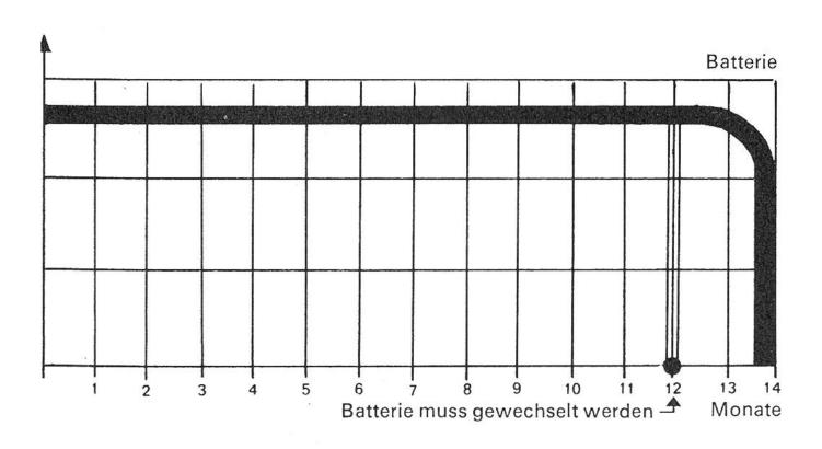
Hohe Präzision für ein ganzes Jahr: dank gleichmässiger Batteriespannung keine Schwankungen wie bei Federspannung.
