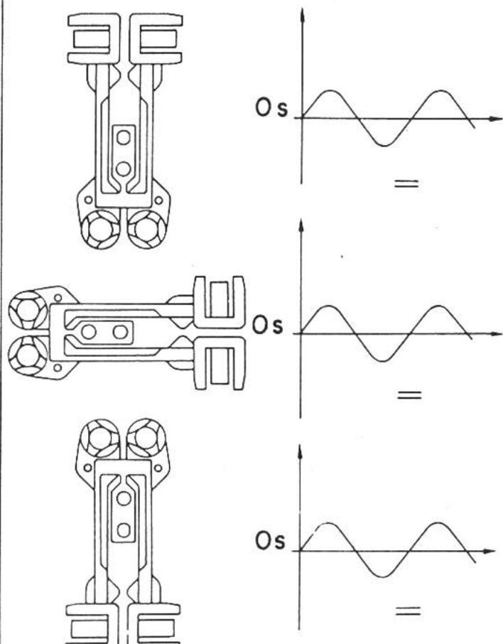
*Der Biegeschwinger im Gleichgewicht schwingt gleichmässig – gleich in welcher Lage.*
