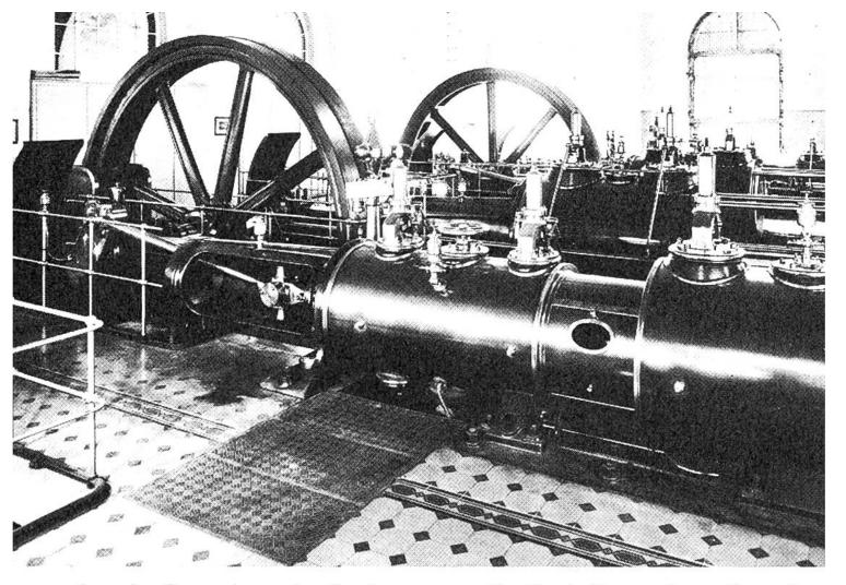
Aus der Sammlung des Technoramas: Dreifach-Expansions-Dampfmaschine, Sulzer 1895, gekoppelt mit Hochdruckkolbenpumpe. Sie förderte während 63 Jahren Trinkwasser vom Bodensee nach dem 400 m höher gelegenen St. Gallen. Der Durchmesser des Schwungrades beträgt 4,7 m, das Gesamtgewicht ist 55 Tonnen.
