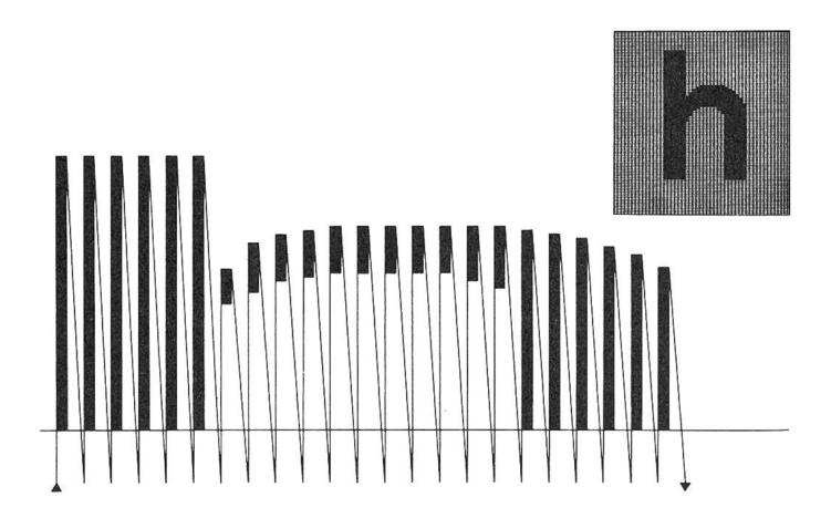
Dieses Bild zeigt den Verlauf der Aufzeichnung durch den Lichtstrahl des Bildrohres. Die Aufzeichnung beginnt unten links beim Nullpunkt. Darauf wird Linie um Linie von unten nach oben aufgezeichnet. Zur Verdeutlichung sind die Bildlinien auseinandergezogen. Oben rechts das aufgerasterte Schriftzeichen.
