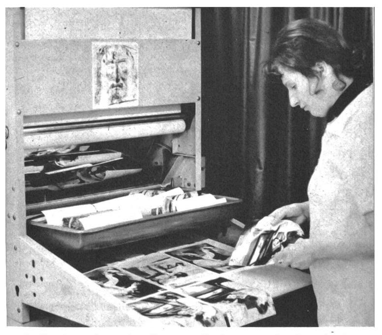
Im Trockengerät werden die nassen Kopien unten eingelegt, durch eine geheizte Trommel getrocknet und verlassen das Gerät mit Glanz.
