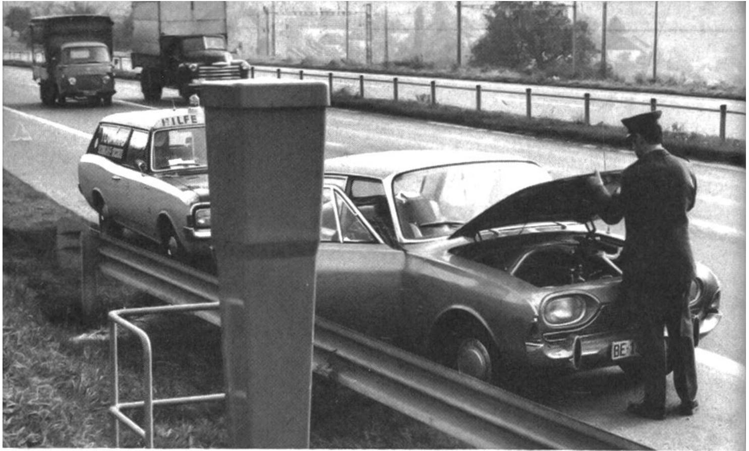
*Auf den Autobahnen erreicht der Automobilist die Strassenhilfe über die Notrufsäulen, die in Abständen von zwei Kilometern beidseitig der Strasse aufgestellt sind.*
