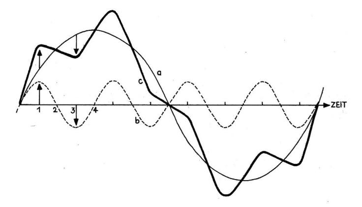
passiert nun mit den Wellen. Wenn sie sich in der gleichen Phase (Abbildung 2: beide über oder unter dem Mittelstrich) befinden, verstärken sie sich (Toni und Hans vor dem Wagen). In der entgegengesetzten Phase schwächen sie sich ab.
