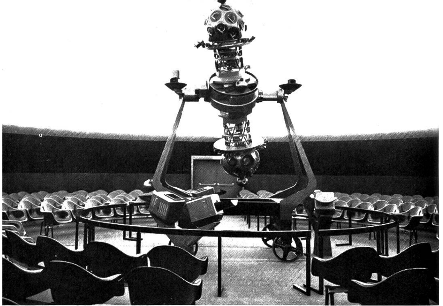
Die halbkugelförmige Planetariumskuppel fasst 300 Personen; sie hat einen Durchmesser von 18 m. In der Mitte das Planetariumsgerät.
