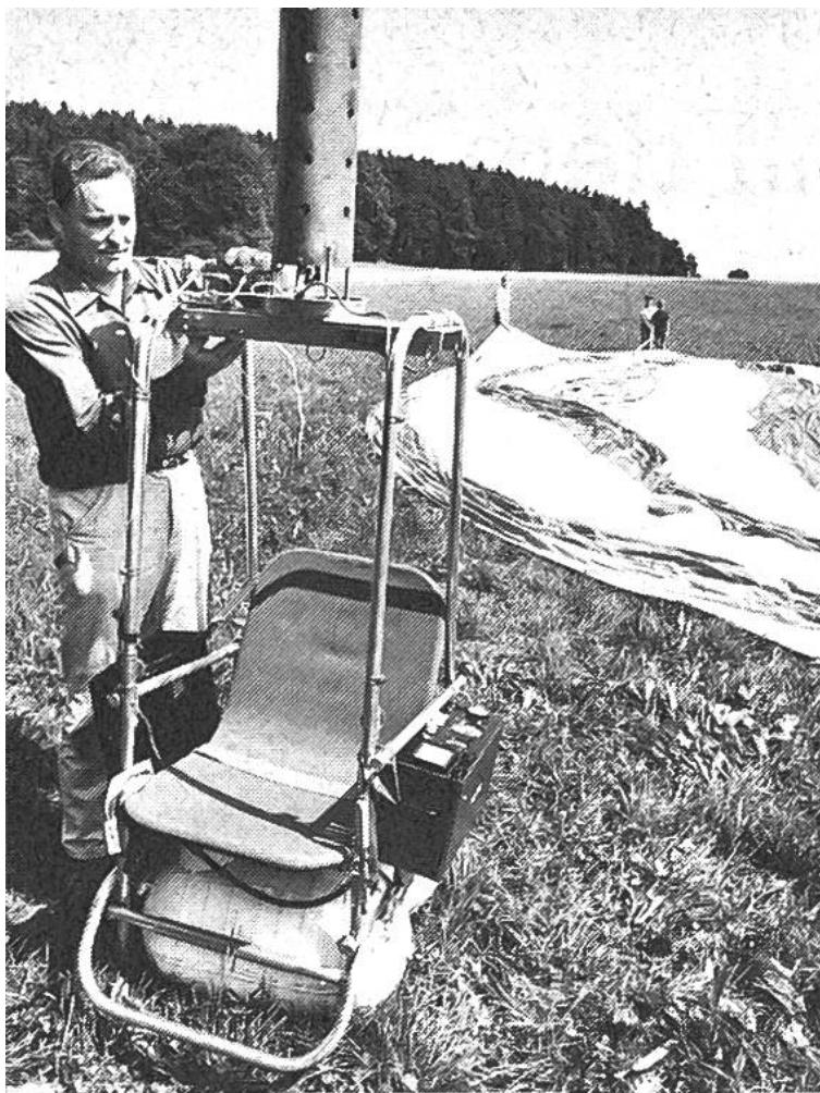
Der Feuerstuhl wird vorbereitet, die zwei Propangasflaschen werden montiert, die Instrumentenboxe und der Funk angehängt und dahinter die Hülle aus reissfestem, hitzebeständigem Nylongewebe ausgelegt.
