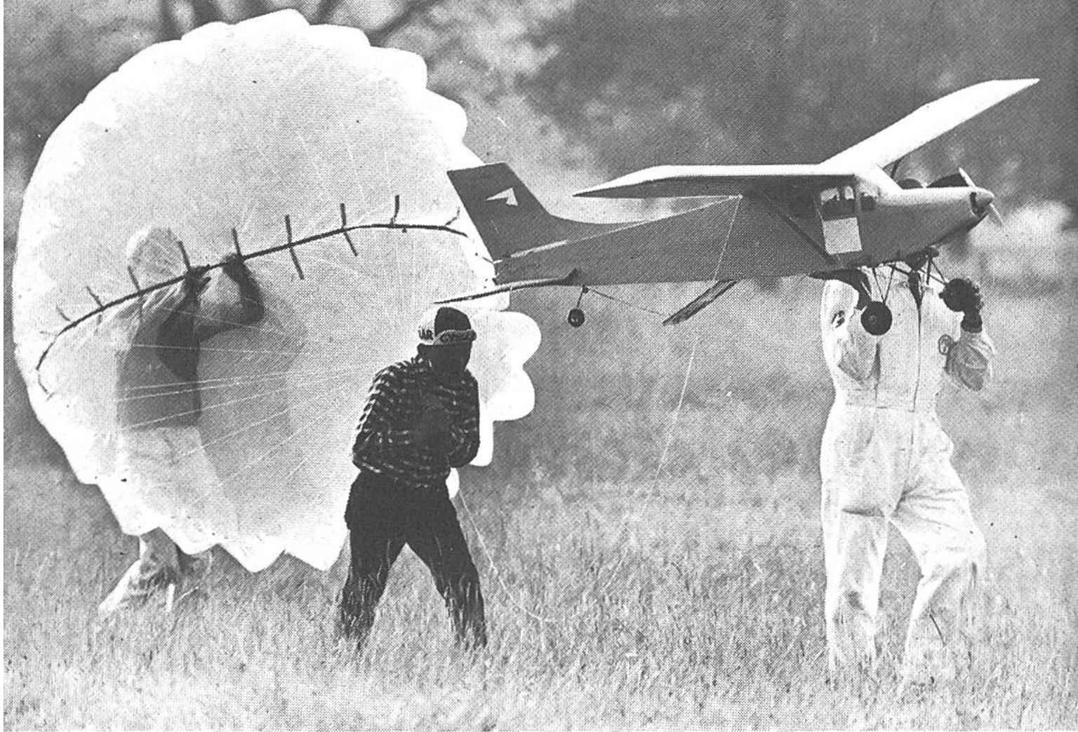
Der Phantasie sind im Modellbau keine Grenzen gesetzt. Dieses Modell zum Beispiel landet auf ferngesteuerten Befehl des Piloten an einem Fallschirm.
