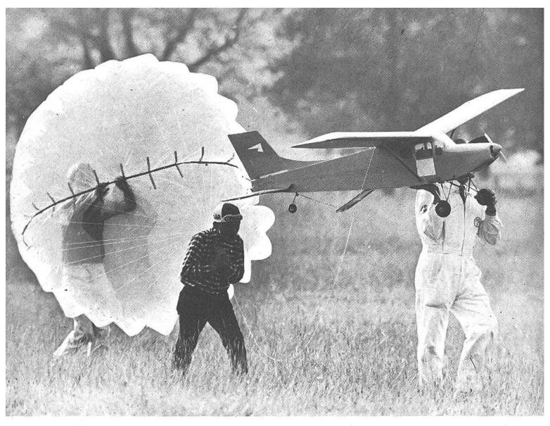
Der Phantasie sind im Modellbau keine Grenzen gesetzt. Dieses Modell zum Beispiel landet auf ferngesteuerten Befehl des Piloten an einem Fallschirm.
