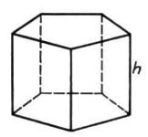
u = Umfang der Grund- oder Deckfläche G n = Zahl der Seitenkanten (Höhenkanten) h Gesamtkantenlänge: 2u+n·h
