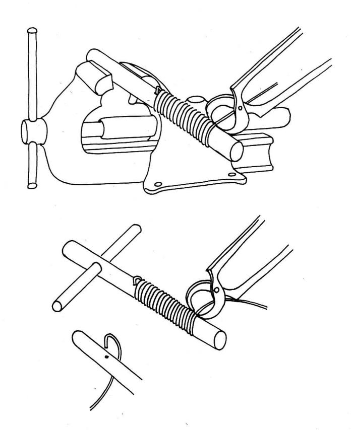
Herstellung der Stahlfeder. Mit der Zange wird der Draht um einen Besenstiel gezogen.
