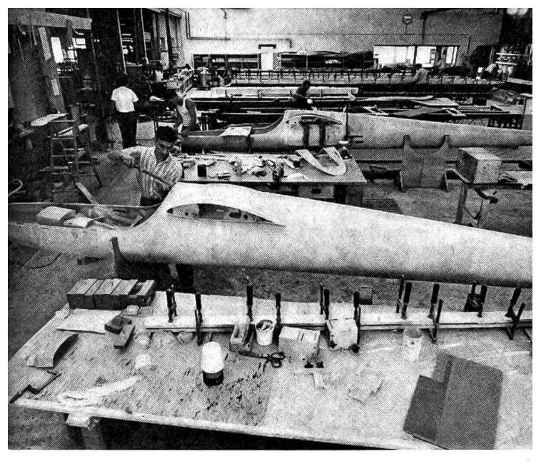
In den Flug- und Fahrzeugwerken Altenrhein wird als erstes serienmässig hergestelltes Kunststoff-Segelflugzeug der Schweiz der «Diamant» fabriziert. Er ist ein ausgesprochenes Hochleistungsflugzeug.
