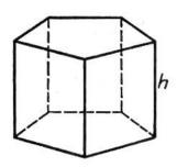
u = Umfang der Grund- oder Deckfläche G n = Zahl der Seitenkanten (Höhenkanten) h Gesamtkantenlänge: 2u+n·h
