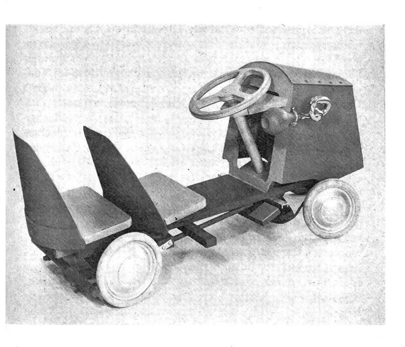
ist besonders dann zu empfehlen, wenn das Grundbrett sehr schmal ist. Die Querleiste mit der darauf befestigten Radachse kann besser mit dem Brett oder Fahrgestell verschraubt werden.
