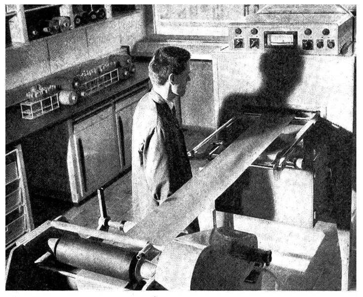
Hochwertige Farbresultate bedingen den intensiven Einsatz von Chemikern und Färbern sowie modernster Apparate. Foulard und Thermofixierapparat einer kontinuierlichen Färbeanlage im Laboratoriumsmaßstab – in der Textilindustrie gebrauchte Modelle sind um ein Vielfaches grösser.
