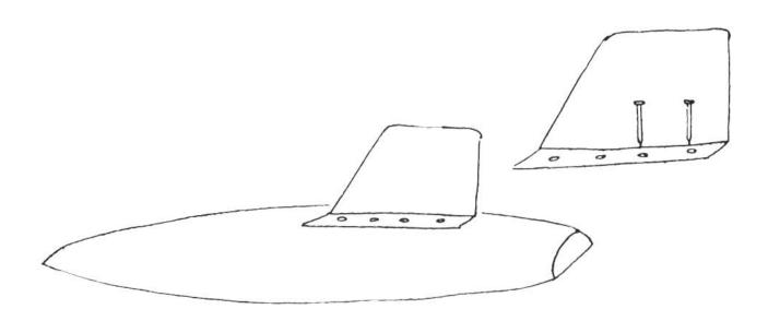
Auf der Oberseite bohren wir das Loch für den Mastbaum. Mittels einer Ringschraube (der Mastbaum wird durch diesen Ring geführt), deren Gewinde in den horizontalen Balken getrieben wird, kann das eine Segel gedreht werden.
