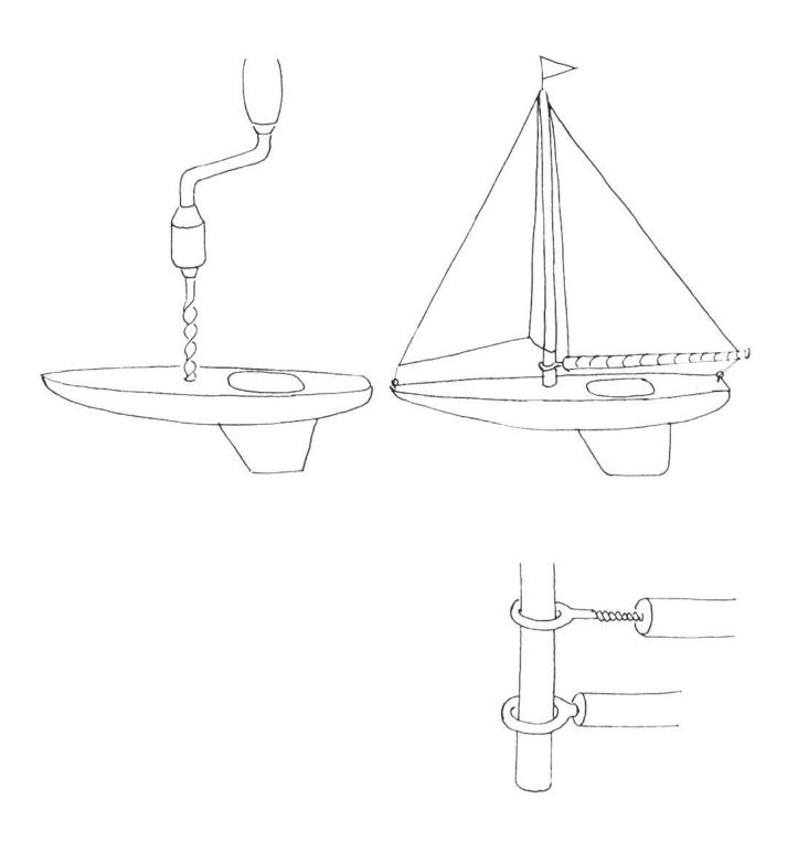
Nachdem das Schiff mit einem wasserfesten Lack zweimal gestrichen worden ist, werden die zugerichteten Segel montiert. Vorne und hinten binden wir sie an kleinen Ringschrauben fest. Das vordere Segel wird unten und oben mit dem Mast verschnürt. Das drehbare Segel verbinden wir unten auf der ganzen Breite mit dem horizontalen Balken (durch Nähen, Festnageln oder Leimen) und hängen es oben von der Mastspitze her auf. Das Boot ist fertig. Gute Fahrt!
