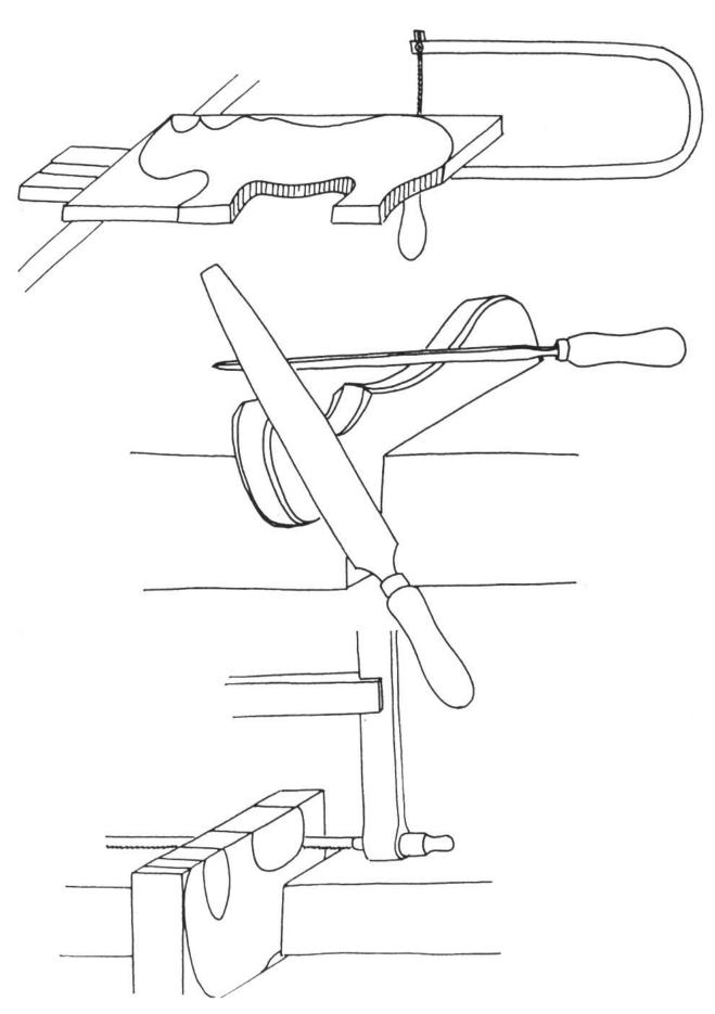
Die vorgezeichneten Tierformen werden ausgesägt. Wenn dünneres, weiches Holz verwendet wird, kann mit der Laubsäge ausgeschnitten werden. Zu diesem Zweck muss ein grobes, starkes Sägeblatt in den Laubsägebogen eingespannt werden. Haben wir dickeres, hartes Holz, muss mit der Schweifsäge (sehr schmales Blatt in der Spannsäge) geschnitten werden.
