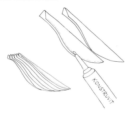
Ballonhülle ein 1½ cm breiter Streifen mit Leim bestrichen wird. Der Drahtring wird sodann eingeschoben, der Leimfalz um diesen herum gezogen und auf der Innenseite mit den Fingern gut angepresst.
