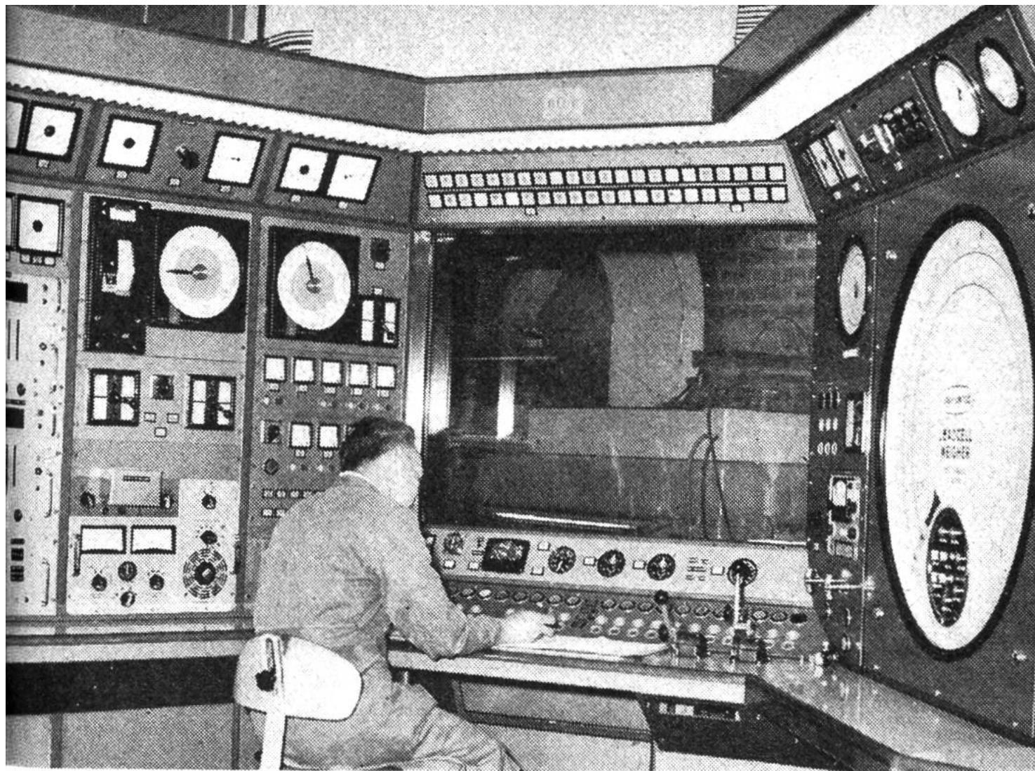
Der Kommandoposten. Anhand der zahlreichen Messinstrumente prüft der Kontrolleur während ungefähr vier Stunden das Triebwerk in allen Situationen, die während eines Fluges eintreten können. Die Prüfwerte werden laufend protokolliert.
