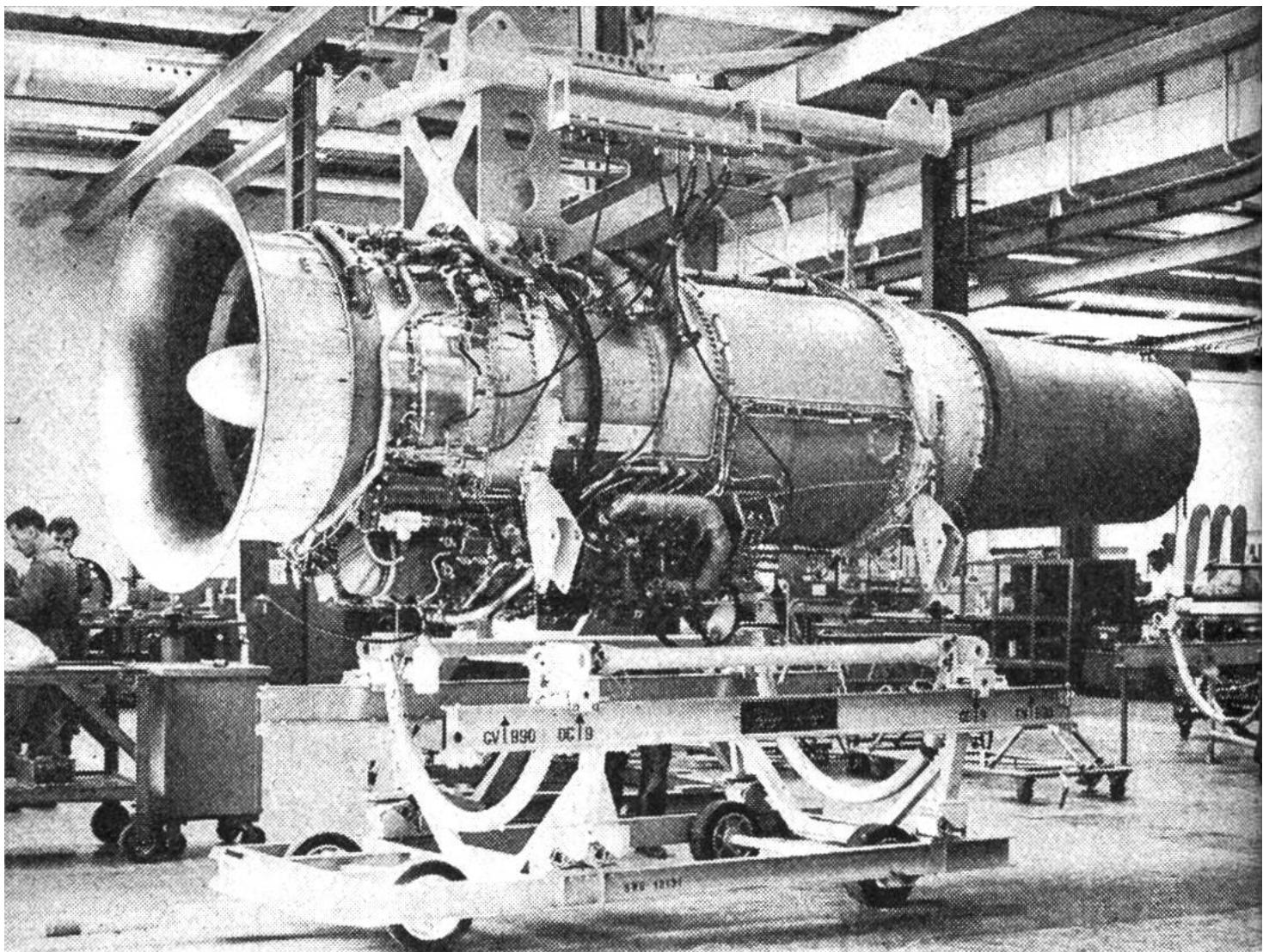
Ein überholtes DC-9-Triebwerk wird in der Motorenwerkstatt mittels eines Laufkrans auf den Rollwagen geladen. Rechts im Bild erkennt man das eigens für den Prüflauf montierte Rohrstück zur Ableitung des Gasstroms in den Schalldämpfer. Die Schalen zur Strahlumleitung wurden für den Prüflauf abmontiert.
