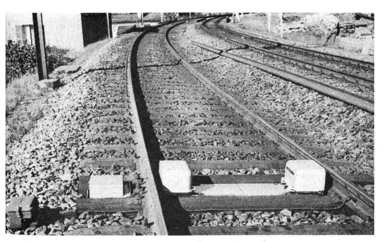
Achszählapparate zählen beim Einfahren eines Zuges in den Blockabschnitt die vorüberrollenden Wagenachsen und steuern automatisch die Blocksignale.
