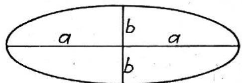
$a$  = halbe grosse Achse     $b$  = halbe kleine Achse
