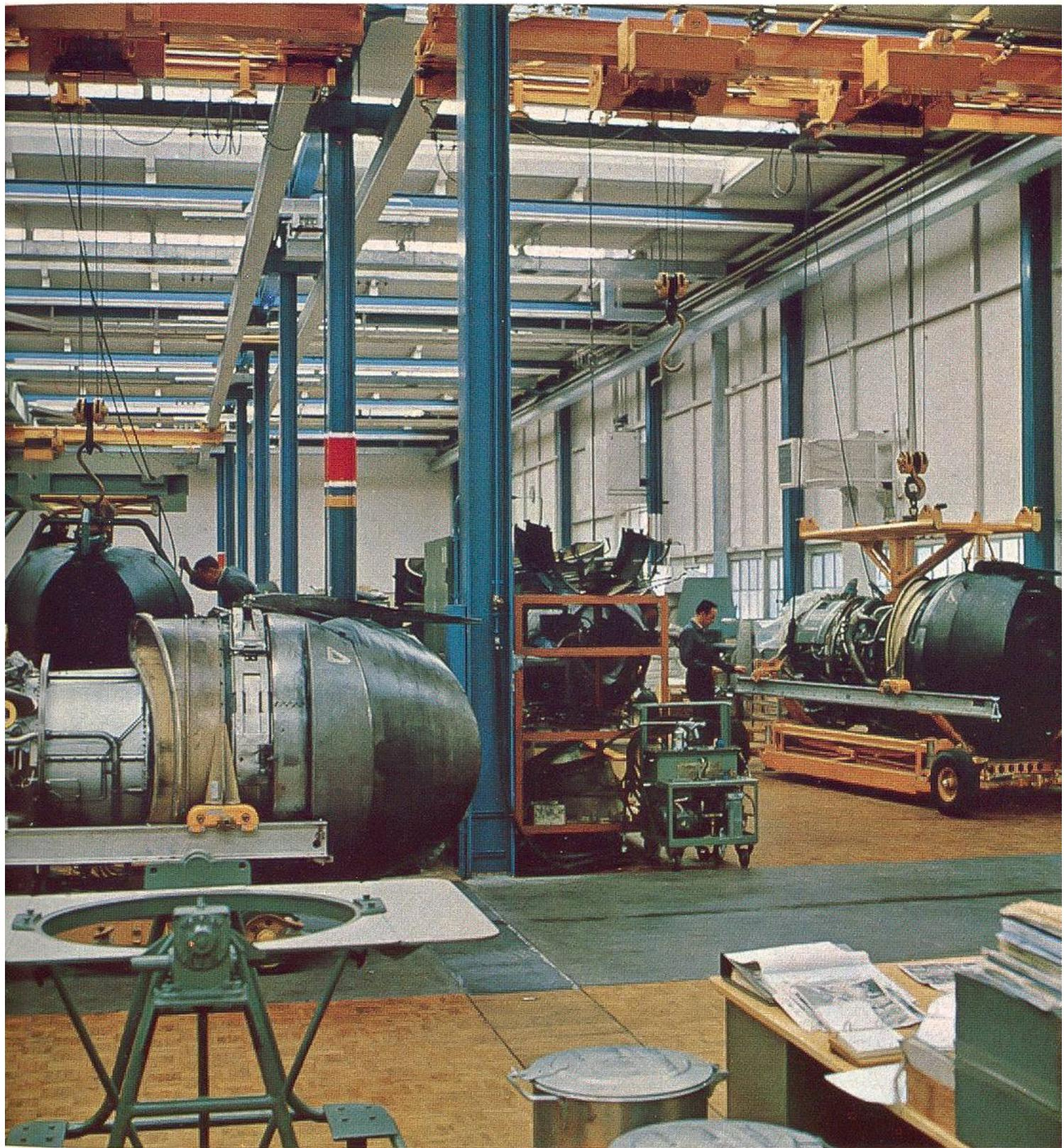
Triebwerke des CV-990 Coronado in der Motorenwerkstätte der Swissair.
