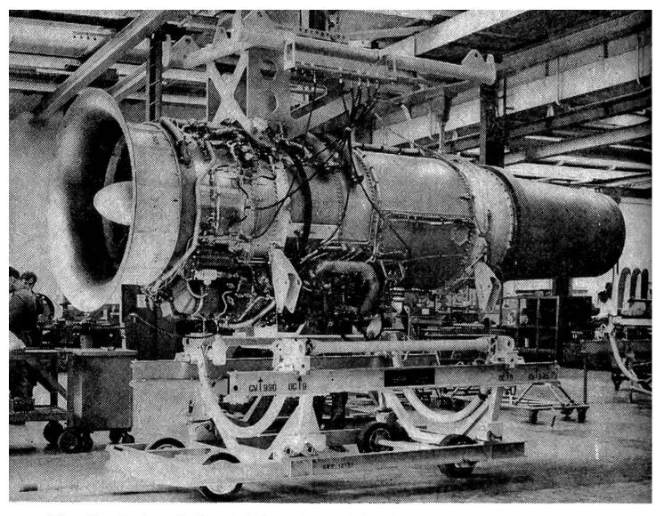
Ein überholtes DC-9-Triebwerk wird in der Motorenwerkstätte mittels eines Laufkrans auf den Rollwagen geladen. Rechts im Bild erkennt man das eigens für den Prüflauf montierte Rohrstück zur Ableitung des Gasstroms in den Schalldämpfer. Die Schalen zur Strahlumleitung wurden für den Prüflauf abmontiert.
