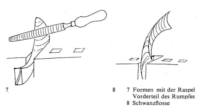
Es ist darauf zu achten, dass die obere und die untere Kantenlinie des Schwanzes elegant und gespannt mit den Rumpfkanten oder Flächen zusammenlaufen. Ist der Fisch mit der Feile bearbeitet, so soll er zum Schleifen nicht mehr eingespannt werden. Die dünne, gewölbte Schwanzflosse erlaubt keine starke Druckbeanspruchung mehr; zum Feinschleifen wird der empfindliche Gegenstand vorsichtig in der Hand gehalten.
