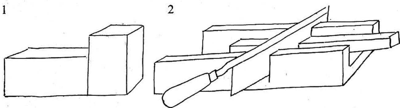
Genau wie die einzelnen kleinen Leistenstücke für die Wagen werden auch die Räder als kleine Holzscheiben von einem Besenstiel oder von einem anderen Holzrundstab in der Schneidlade weggesägt.
