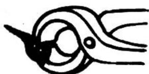
Damit zwei Ringschrauben ineinander eingehängt werden können, wird der Ring mit der Beisszange aufgetrieben und nach dem Eihängen durch Zusammenklemmen wieder geschlossen.
