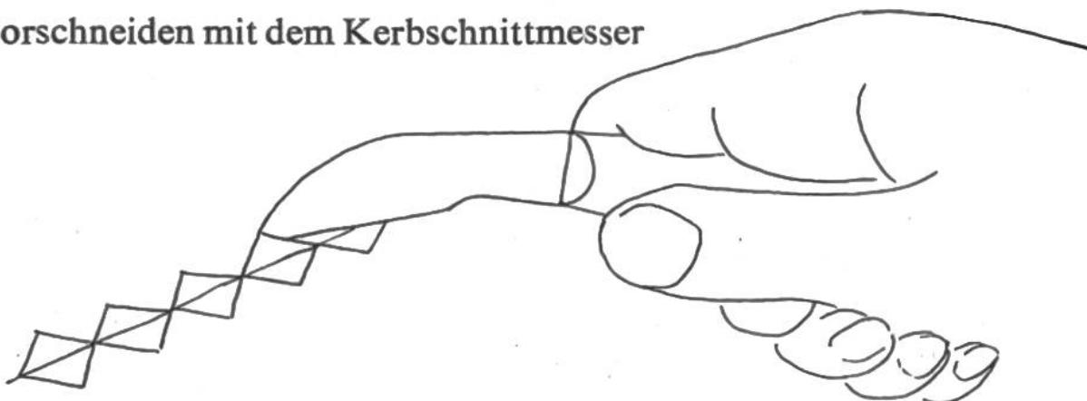
Das Ausheben dieser vorgeschnittenen Dreiecke mit dem gleichen Kerbschnittmesser geht folgendermassen: Beim Vorschneiden der Dreiecke wird senkrecht zur Fläche geschnitten, beim Ausheben steht die Schnittflucht schräg zur Brettfläche (Skizze).
