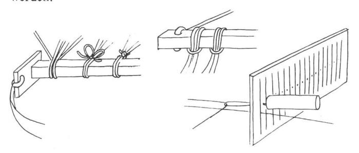
Die Fäden sind zuerst nur mit einer leicht lösbaren Schlinge zu knüpfen; erst, wenn überprüft wurde, ob alle Fäden gleich stark gespannt und in exakter Reihe durch das Webbrett laufen, kann die lose Schlaufe fest verknotet werden. Der Kettbaum soll zu dieser Arbeit festgeklemmt sein.
