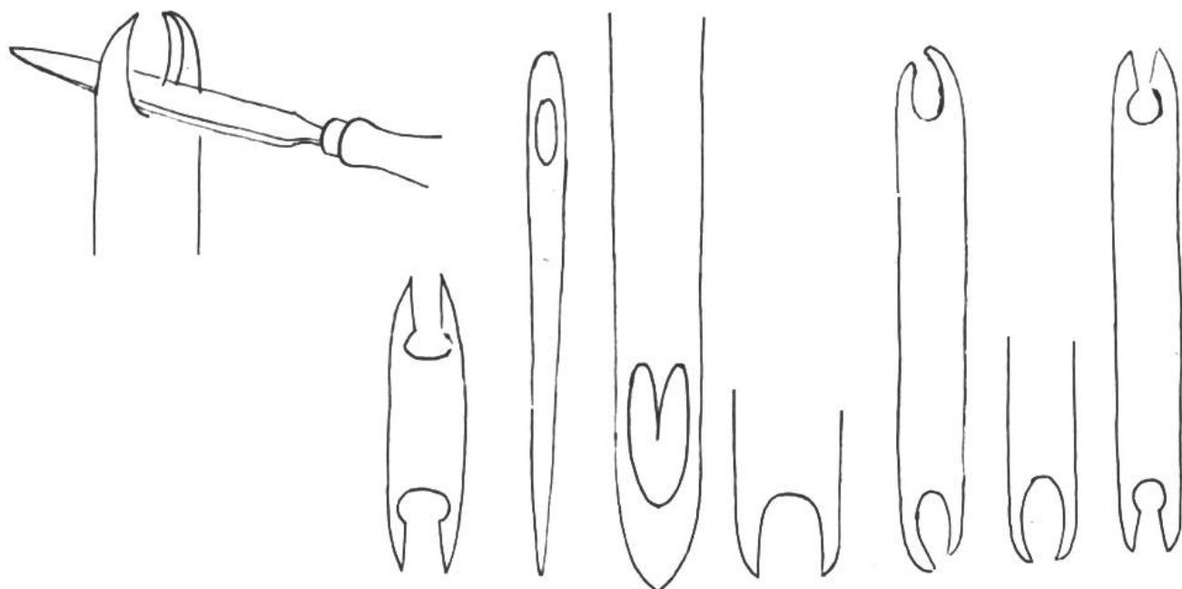
Die mit der Laubsäge ausgeschnittenen Formen werden mit Schlüsselfeilen sauber verputzt. Mit Schleifpapier werden alle Werkzeugspuren und Unregelmässigkeiten korrigiert und ausgeglichen. Alle scharfen Kanten werden gebrochen. Das Schiffchen sollte nicht aus der Hand gelegt werden, bis es, mit feinstem Schleifpapier behandelt, sich tadellos, wie ein edles Werkzeug, präsentiert.
