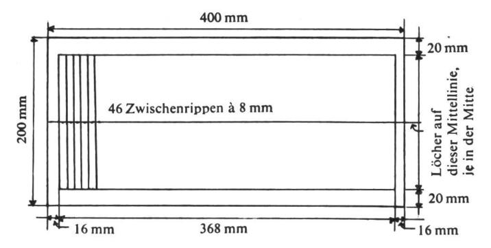
mit auch ein breites, grobes Laubsägeblatt in das Loch eingeführt werden kann, werden 2-3 Löcher exakt auf der vorgezeichneten Linie ohne Zwischenraum als Schlitz nebeneinander gebohrt. Beim Sägen mit der Laubsäge ist darauf zu achten, dass die Säge immer senkrecht zum Blatt geführt wird und dass der Schnitt genau durch die vorgezeichneten Linien verläuft.
