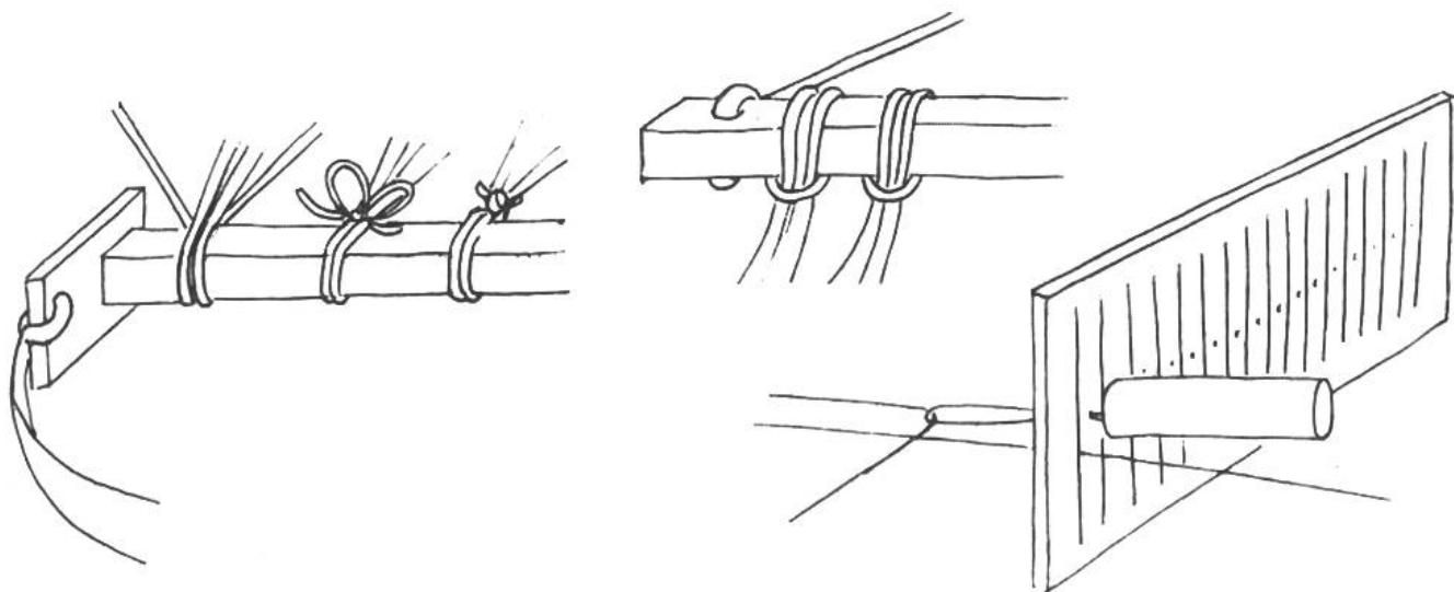
Die Fäden sind zuerst nur mit einer leicht lösbaren Schlinge zu knüpfen; erst, wenn überprüft wurde, ob alle Fäden gleich stark gespannt und in exakter Reihe durch das Webbrett laufen, kann die lose Schlaufe fest verknotet werden. Der Kettbaum soll zu dieser Arbeit festgeklemmt sein.
