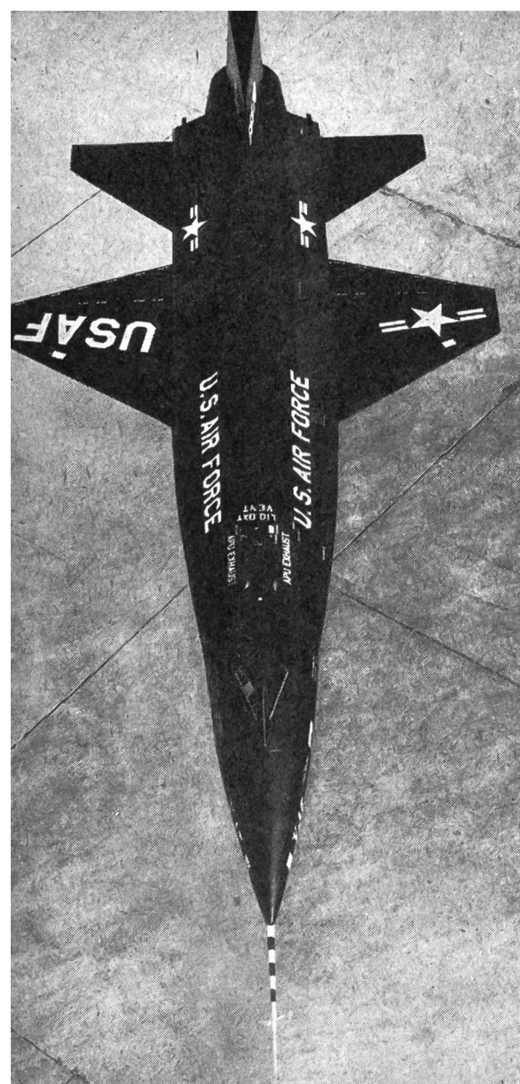
Das Versuchs-Raumflugzeug X-15 soll bis in 120 km Höhe vorstossen und Mach 8 erreichen. Als Antriebsmittel dienen dem Raketentriebwerk Flüssigwasserstoff und Flüssigsauerstoff.
