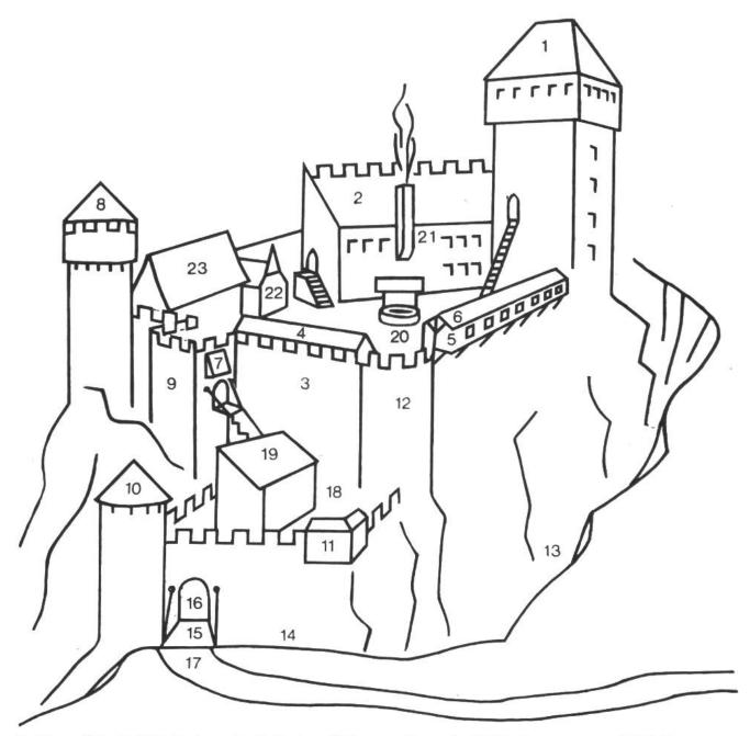
1 Bergfried (Wehrbau), 2 Palas (Herrenhaus), 3 Wehrmauer, 4 Wehrgang, 5 Schießscharten, 6 Wehrgang, 7 Pechnase, 8 Mauerturm, 9 Torturm, 10 Flankenturm, 11 Streichwehr, geschützte Schießscharten, 12 Schalenturm, 13 Halsgraben, 14 Torgraben, 15 Fallbrücke, 16 Burgtor, 17 Burgweg, 18 Zwinger, 19 Torhaus, 20 Sodbrunnen, 21 Heizung, 22 Burgkapelle, 23 Wohnbauten für Dienstleute und Gesinde, Stallungen.
