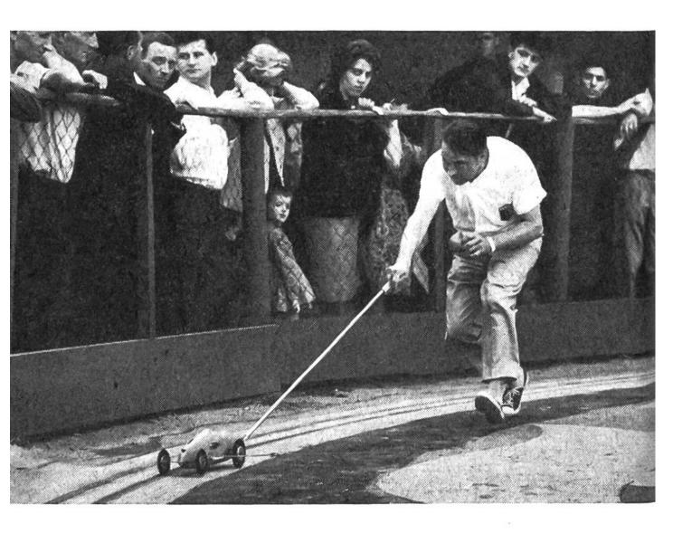
So wird ein «Rennauto» gestartet: mit dem Anschiebestock wird der Wagen angestossen. Und spielend kann das Auto Geschwindigkeiten von 200 km/h oder mehr erreichen.
