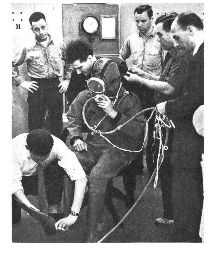
Im Mai 1961 demonstrierte ich meine Tauchmethode vor Fachleuten der amerikanischen Marine. Im Taucherlaboratorium wurde ich in einer Druckkabine künstlich unter einen Wasserdruck gebracht, der gleich gross war wie der Druck in einer Meerestiefe von 215 m. Durch die Fenster der Druckkabine und mit zwei Fernsehanlagen beobachteten mich die Fachleute während des ganzen Versuchs und vor allem während meiner Arbeitsleistung unter dem hohen Druck.
