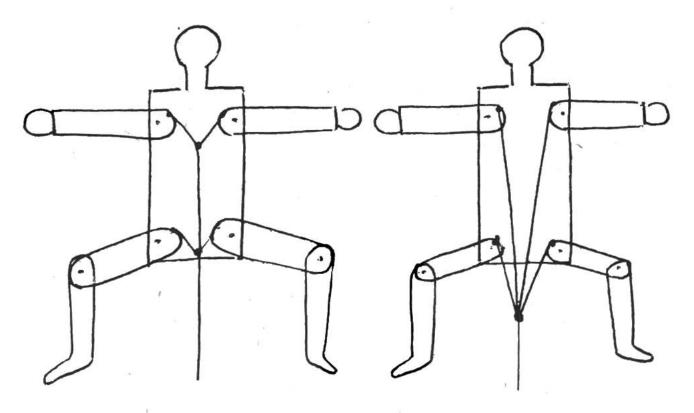
Eine zweite, etwas kompliziertere Konstruktion wird meist dann angewendet, wenn man den Hampelmann auf beiden Seiten dekorieren will. Der Rumpfteil wird 2mal ausgesägt. Arme und Beine bewegen sich um eine Holzachse, welche zugleich den hinteren und vorderen Rumpfteil miteinander verbindet. Die Holzachsen bestehen aus einem Holzrundstab von 6–8 mm Durchmesser. An den Gelenkstellen werden gleich alle 3 Teile (vorderer und hinterer Rumpfteil und bewegliches Glied dazwischen) miteinander durchbohrt.
