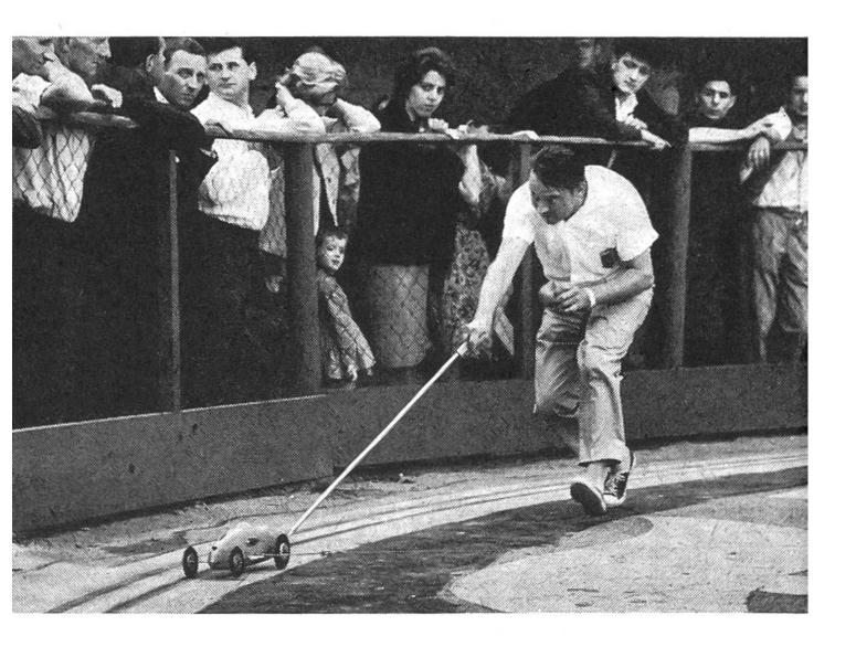
So wird ein «Rennauto» gestartet: mit dem Anschiebestock wird der Wagen angestossen. Und spielend kann das Auto Geschwindigkeiten von 200 km/h oder mehr erreichen.
