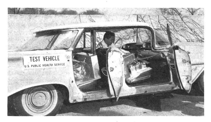
Testfahrzeug der amerikanischen Gesundheitsbehörden. Das Fahrzeug ist mit Instrumenten ausgerüstet, um die Abgase während der Fahrt zu messen.
