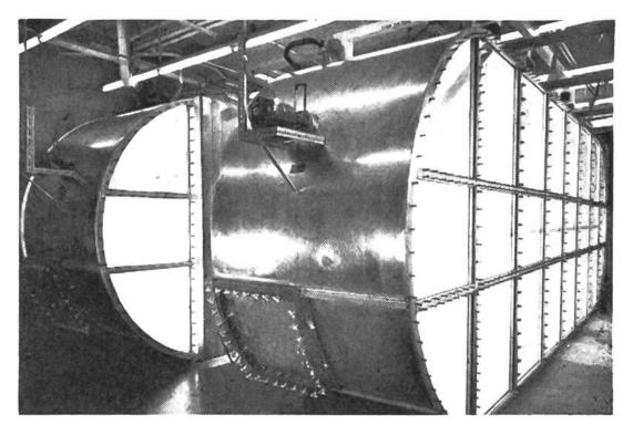
Seitenansicht einer Bestrahlungskammer. Abgase werden mit künstlichem Sonnenlicht bestrahlt und die Zunahme der Giftigkeit gemessen.
