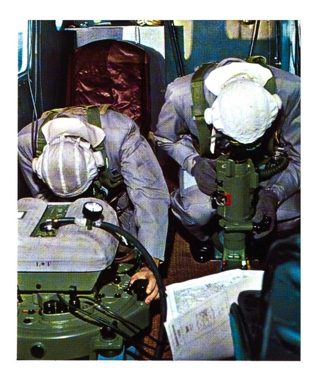
Die Aufnahme-Equipe im Innern des Flugzeuges beim Bedienen der photogrammetrischen Aufnahmekamera (links) und des Navigationsfernrohrs (rechts).
