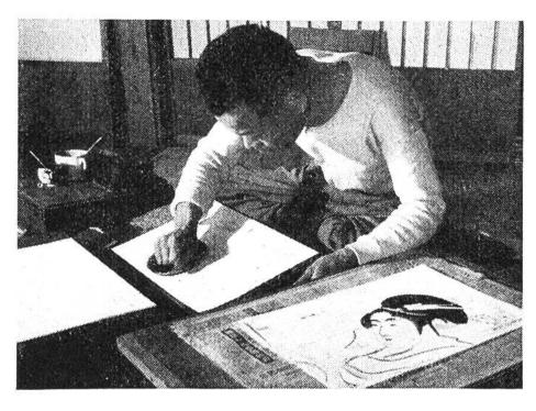
Der Drucker beim Streichen der Rückseite des Papierbogens gegen die Druckplatte mit einer mit Bambusrinde überzogenen Scheibe.
