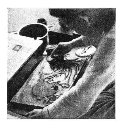
Der Drucker trägt mittels einer Bürste die schwarze Farbe auf die erste Druckplatte auf.
