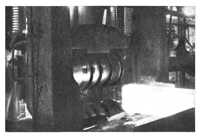
Auswalzen der glühenden Stahl-Ingots im Walzwerk.
