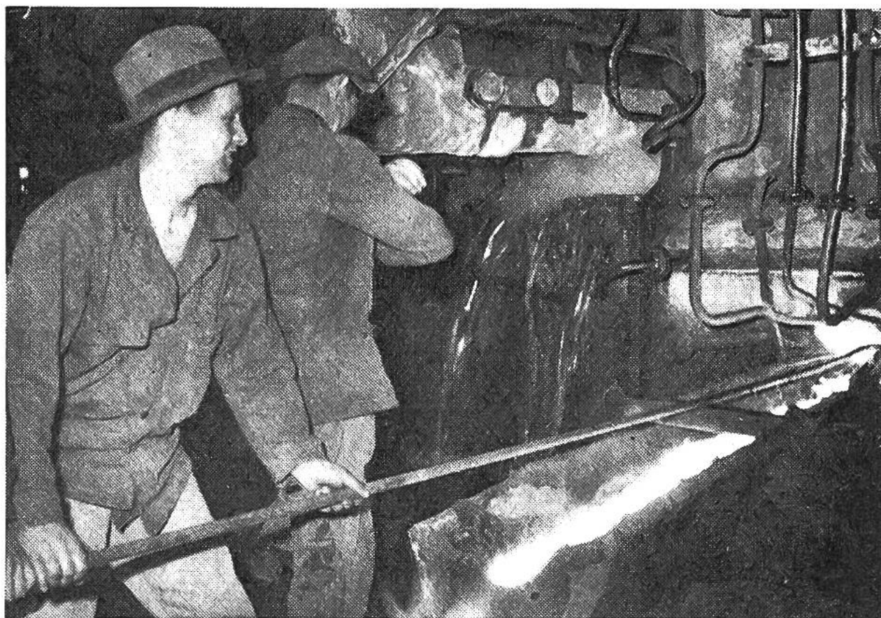
Der Abstich des Hochofens: Ausfliessen des flüssigen Roheisens.
