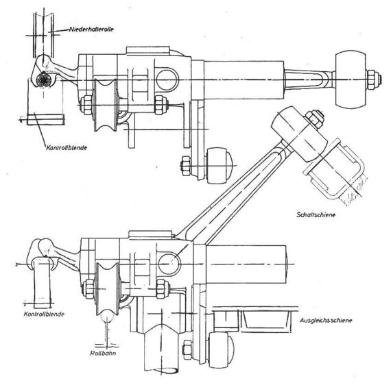
Beispiel einer automatischen Klemme für Einseilbahnen. Oben der Apparat im Betrieb. Das Seil ist zwischen den Klemmbacken eingespannt. Beim Verlassen der Station wird die richtige Klemmstellung mit einer Blende geprüft. Darunter der offene Apparat vor dem Einkuppeln auf der Rollbahn. Die Lage des Apparates wird mit einer Ausgleichsschiene gegen Kippen unter der Wirkung des Hebeldruckes auf die Schaltschiene gesichert.
