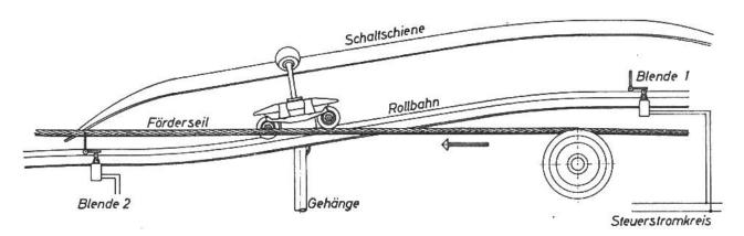
Schematische Darstellung einer Einkuppelstelle. Auf der schiefen Rollbahn wird der Klemmapparat auf die Seilgeschwindigkeit gebracht. Blende 1 prüft, ob der Apparat voll offen ist. Wenn nicht, kippt die berührte Blende um und öffnet den Steuerstromkreis des Antriebsmotors. Sofortige Bremsung folgt. Blende 2 hat die gleiche Wirkung, wenn das Seil schlecht erfasst wurde.
