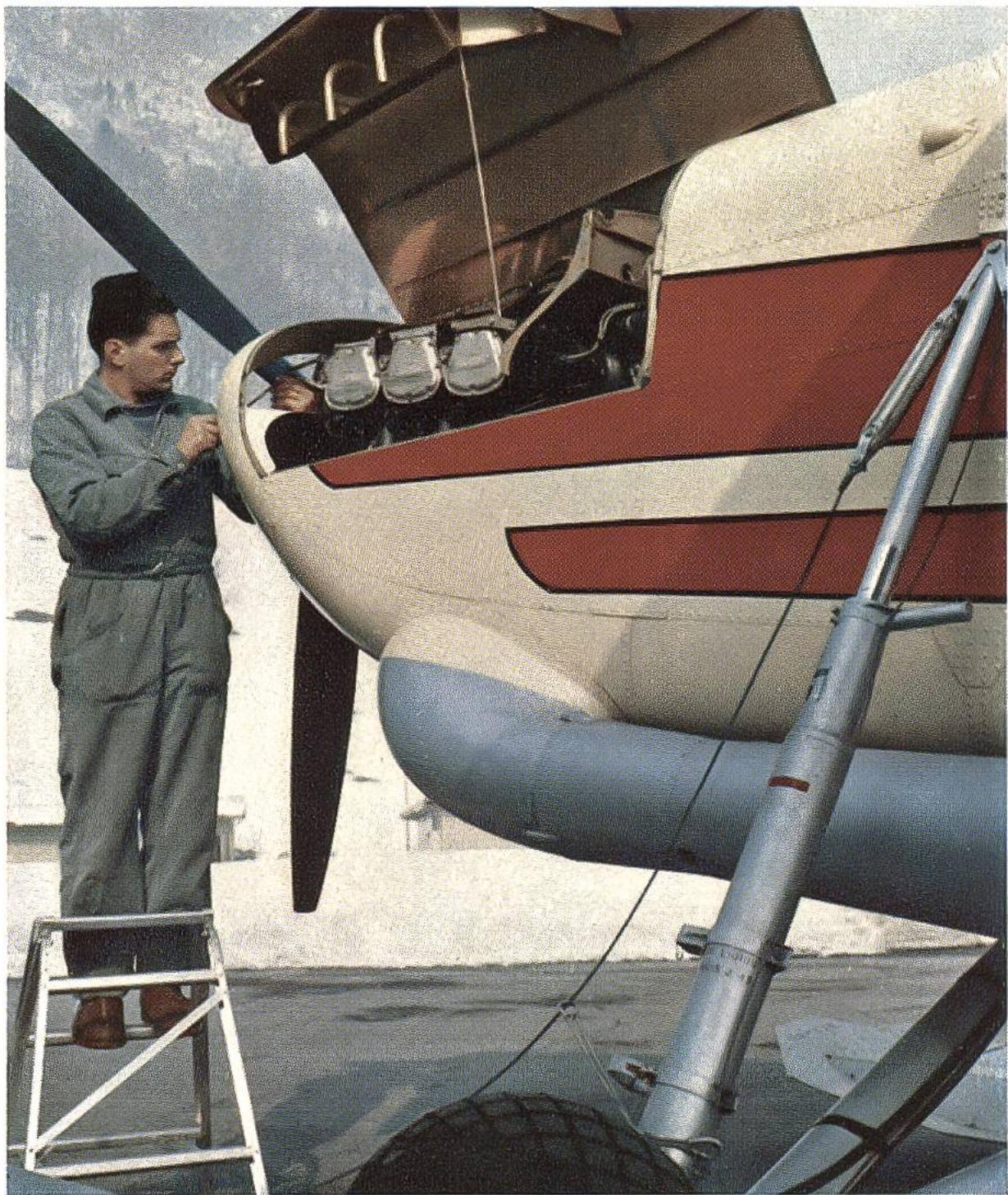
Transportflugzeug «Porter» der Pilatus-Flugzeugwerke in Stans. Das äusserst günstige Eigengewicht dieses Flugzeugs, welches für Rettungsaktionen in den Bergen und für Himalaya-Expeditionen eingesetzt wird, beträgt ca. 1100 kg. Gerippe, Verkleidung und Propeller sind aus legiertem Aluminium hergestellt.
