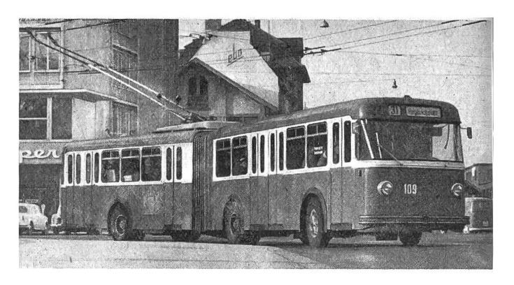
Gelenktrolleybus, Baujahre ab 1957, bietet bei einer Länge von 16,1 m 124 Personen Platz. Die beiden Motoren leisten zusammen 280 PS. Insgesamt stehen 33 Fahrzeuge in Betrieb.
