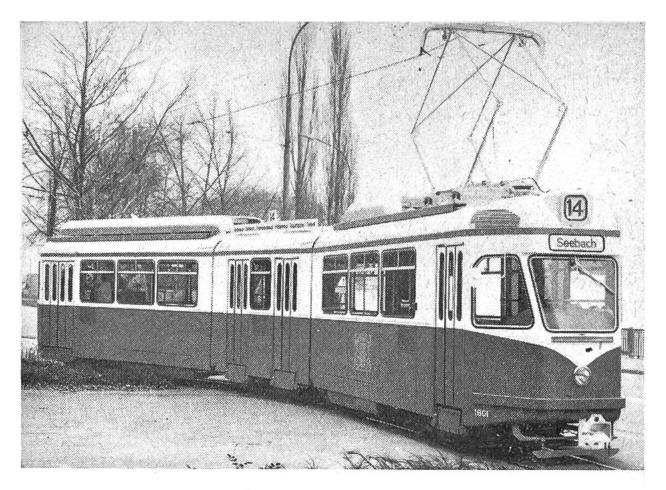
Strassenbahn-Gelenkmotorwagen, Baujahr 1961, bietet bei einer Länge von 20,4 m 165 Personen Platz. Die 6 Motoren leisten zusammen 540 PS. 30 weitere solche Wagen (aber mit 4 Motoren) wurden in Auftrag gegeben.
