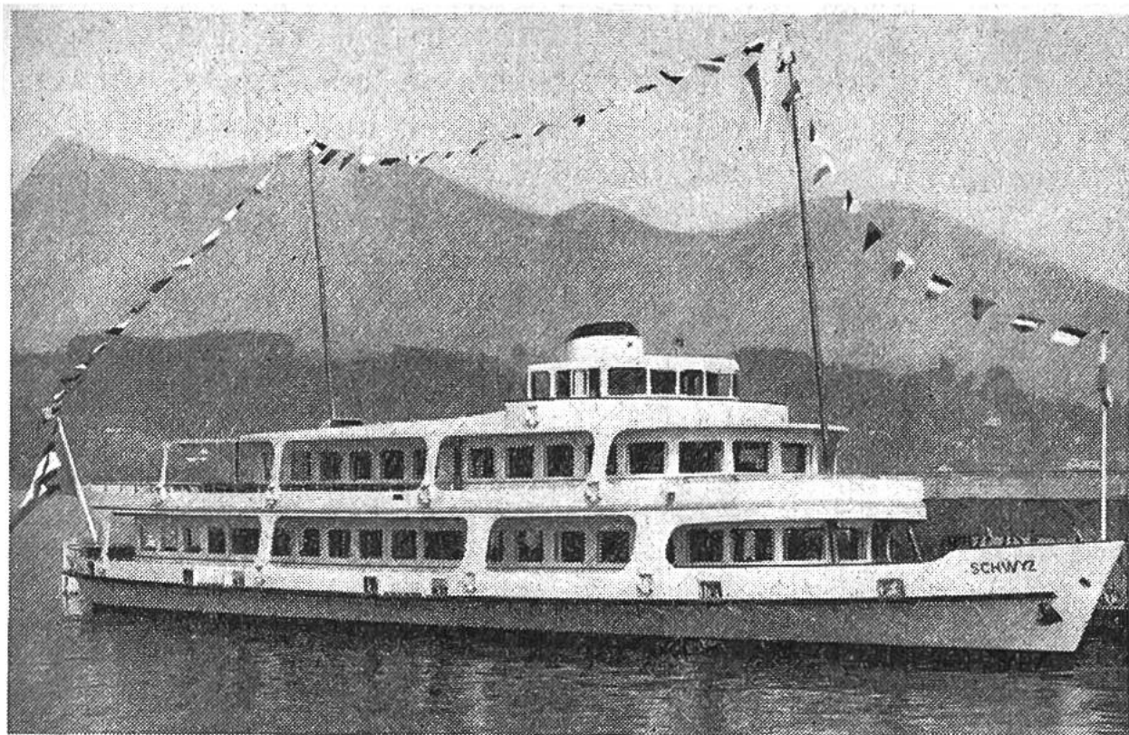
MS «Schwyz» der Dampfschiffgesellschaft des Vierwaldstättersees mit seinen Oberbauten aus Leichtmetall, durch dessen Verwendung ein Totgewicht von ca. 25 Tonnen (= Gewicht von ca. 330 Personen) eingespart werden konnte.
