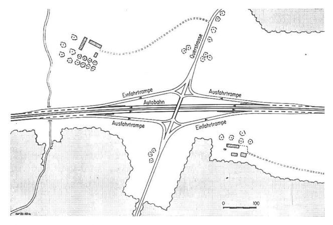
Generelles Projekt eines Autobahnanschlusses. Dieser Anschluss hat die Form einer Raute. Sichtbar sind die Ein- und Ausfahrtrampen und das Überführungsbauwerk über die Autobahn.
