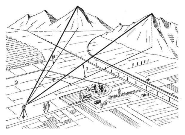
Schematische Darstellung der Winkelmessung.  $\alpha = \text{Horizontal winkel}, \beta = \text{H\"{o}}\text{henwinkel}.$
