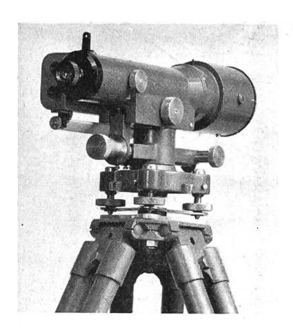
gangspunkt; in einem Abstand von höchstens 40-50 m wird das Instrument aufgestellt, und im gleichen Abstand nach vorn kommt noch eine 2. Latte. Sind die Ablesungen an diesen Latten gemacht, so können das Indie strument und hintere Latte nach
