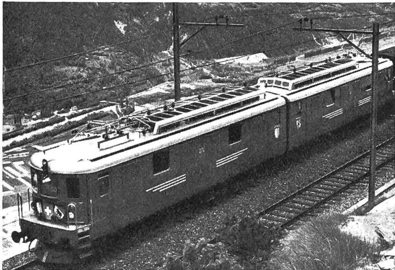
Dem Schnellzugs- und besonders dem Schwergüterverkehr der BLS dienen seit 1959 Doppellocmotiven (Ae 8/8), die mit 8800 PS eine Anhängelast von 900 Tonnen auf 27‰ Steigung mit 75 km/h zu befördern vermögen. Sie sind ca. 30 m lang und 160 t schwer. – Südrampe, Blick ins Rhonetal (siehe S. 227).
