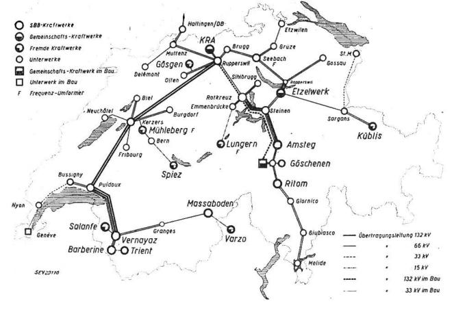
Übersichtsplan der Kraftwerke und Hochspannungs-Verteilleitungen des Netzes der Schweizerischen Bundesbahnen für das Bahnstromsystem von  $16^2/_3$  Hertz. Dieses Produktions- und Verteilsystem ist von demjenigen der allgemeinen 50-Hertz-Elektrizitätsversorgung getrennt.
