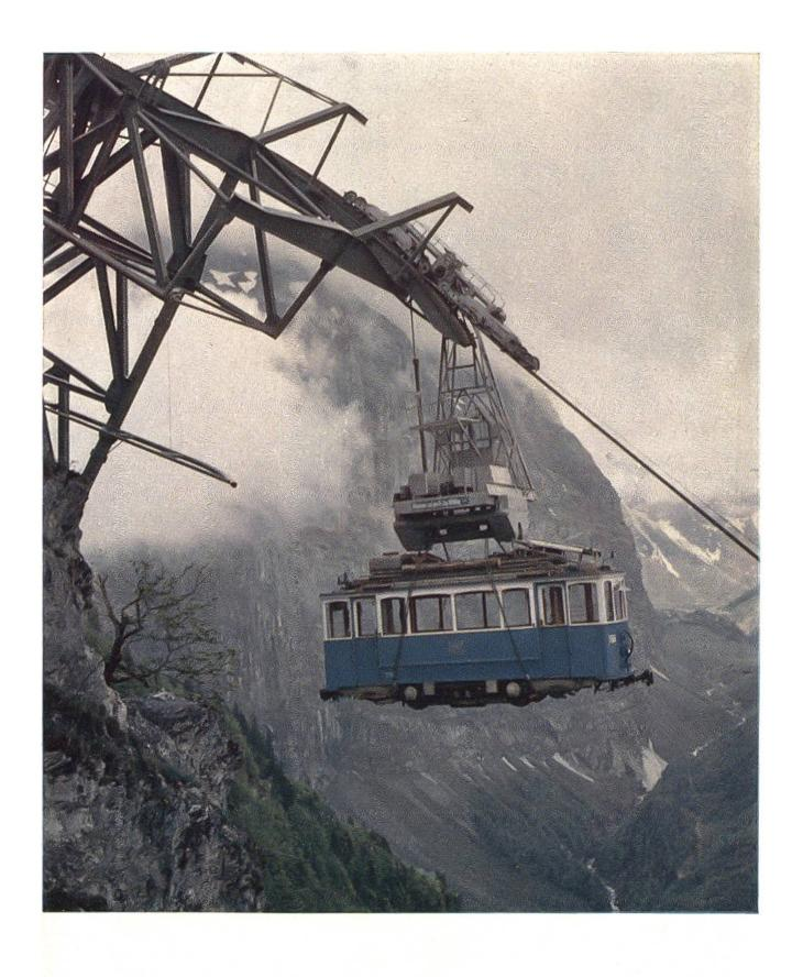
Schwerlastseilbahn Tierfehd (Kraftwerke Linth-Limmern) transportiert einen Zürcher Tramtriebwagen auf die Höhe der Baustelle.
